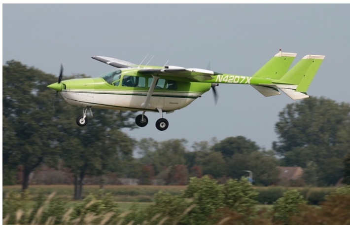
Figuur 13: Hybride testvliegtuig ontwikkeld door kenniscentrum DEAC 71
