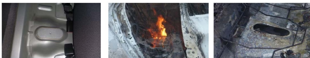
Figuur 2.8 Brandweer vulopening in een Renault ZoE voor, tijdens en na een brandtest (Petit Boulanger et al., 2016)
