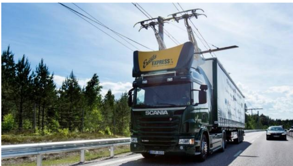
Figuur 34: eHighway van Siemens
