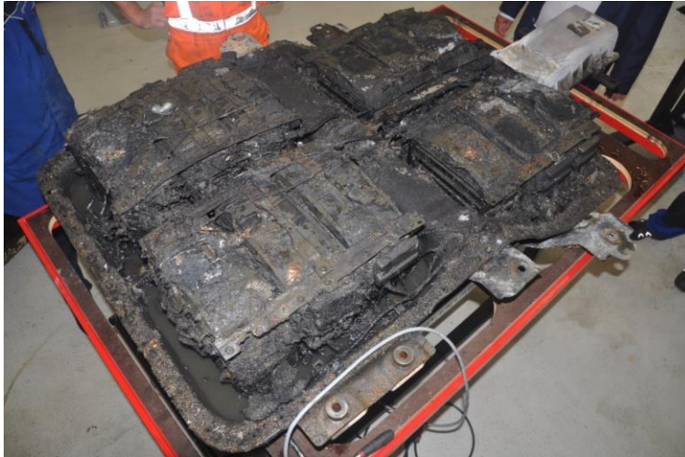
Afbeelding B4.18 Binnenzijde van accupakket met de vier accueenheden
