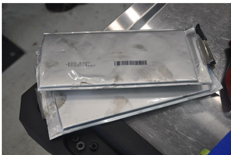
Afbeelding B4.2 Voorbeeld van twee pouch cellen
