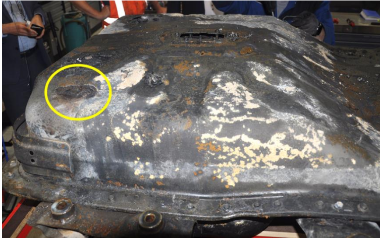
Afbeelding B4.13 Gat in het gedeelte van het accupakket onder de achterbak
