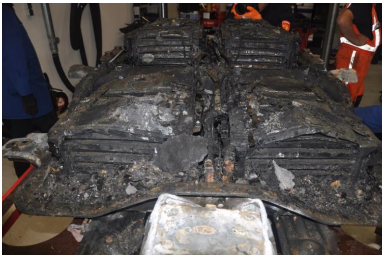
Afbeelding B4.19 Bol staan van bovenzijde van de accueenheden
