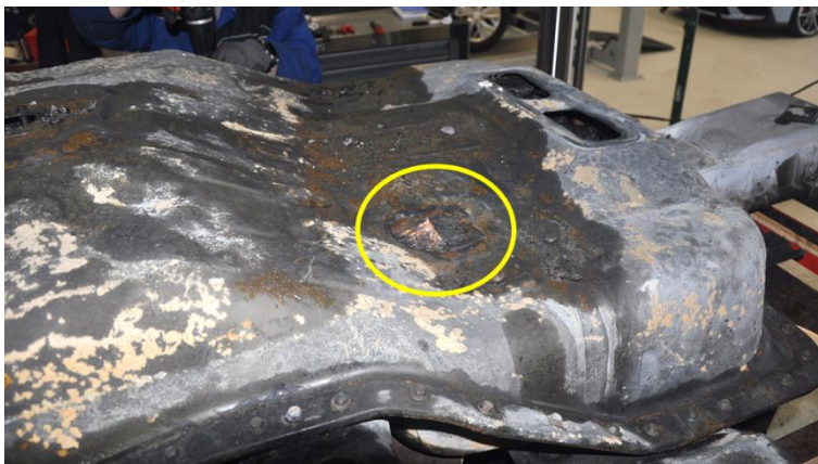
Afbeelding B4.14 Gat in het gedeelte van het accupakket onder de passagiersstoelen
