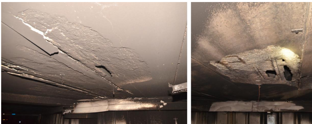
Afbeelding 4.5 Links plafondconstructie boven het elektrische voertuig, rechts boven het conventionele voertuig
