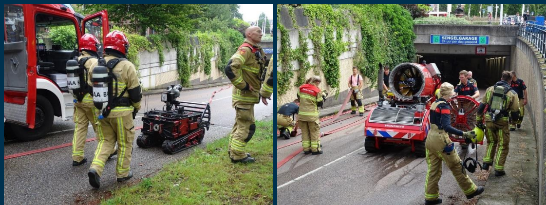
Afbeelding 6.1 Links: De blusrobot van Amsterdam-Amstelland, rechts: De robot van Haaglanden (Foto's: Hans Peter Olivier en Evelien Olivier-Wittenberg)
